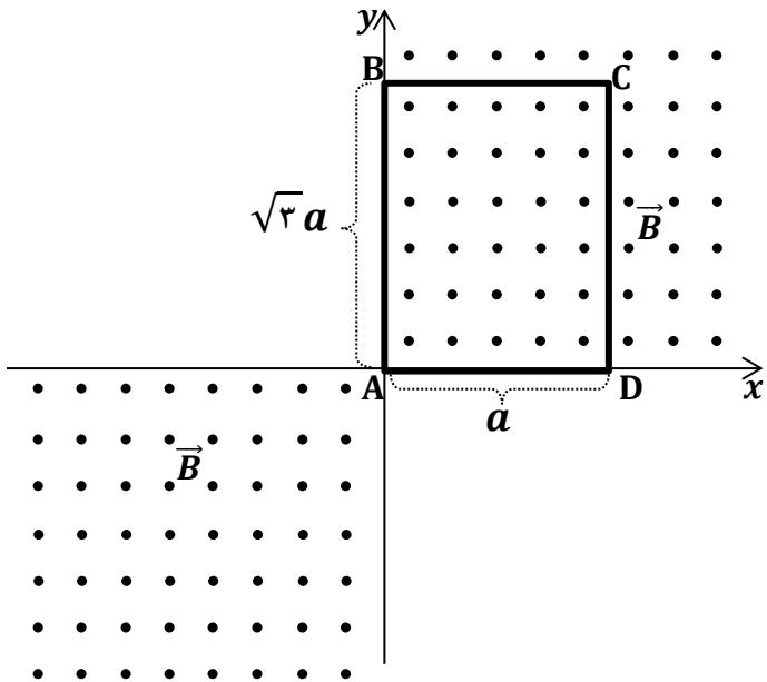
(آ) اگر میدان  $\vec{B} = B_0 \hat{k}$  عمود بر صفحه قاب در ربع اول و سوم مختصات برقرار باشد، شار میدان مغناطیسی را در یک دور کامل چرخش در تمام زمان‌ها بر حسب  $a$ ،  $\omega$ ،  $B_0$  و  $t$  بدست آورید. (نیم خط عمود بر صفحه قاب را در جهت  $\hat{k}$  در نظر بگیرید).
