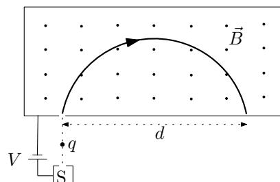
۲۰) در شکل، نمایی از یک دستگاه جداکننده جرم که برای اندازه‌گیری جرم یون‌ها به کار می‌رود، نشان داده شده است. در این دستگاه یون‌هایی که در چشمء  $S$  تولید شده‌اند، تحت تأثیر پتانسیل الکتریکی  $V = 1000$  شتاب می‌گیرند و وارد اتاقکی می‌شوند که در آن میدان مغناطیسی  $T = 8 \times 10^{-2}$ ، عمود بر صفحه شکل، برقرار است.
