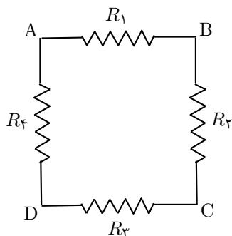
۳) در مدار مقابل اگر یک باتری را بین نقاط A و B یا بین نقاط C و D وصل کنیم توان الکتریکی مصرفی در مدار  $P$  است. اگر همان باتری بین نقاط A و D یا بین نقاط B و C بسته شود توان الکتریکی مصرفی  $\frac{65}{9}P$  است. نسبت  $\frac{R_1}{R_2}$  چقدر است؟
