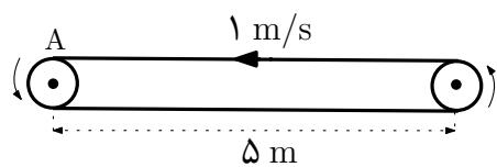
ضریب اصطکاک جنبشی بین تسمه و جسم  $25/2$  و طول تسمه نقاله  $5 \text{ m}$  است. شتاب گرانش را  $g = 10 \text{ m/s}^2$  بگیرید. حداقل  $v$  چقدر باشد تا جسم از سمت مقابل A از روی تسمه نقاله پایین نیافتد.
