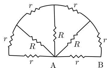
۲) مقاومت الکتریکی بین دو نقطه‌ی A و B در شکل چقدر است؟
