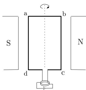
۲۱) موتور الکتریکی ساده از یک قاب abcd که می‌تواند دور محورش بچرخد درست شده است. دور این قاب چند دور سیم نازک روکش دار پیچیده شده و قاب میان دو قطب آهنربا قرار دارد. دو سر سیم‌های پیچیده دور قاب به یک باتری وصل می‌شود و جریانی در سیم‌پیچ به وجود می‌آید. نیروی ناشی از تأثیر میدان مغناطیسی بر جریان الکتریکی، قاب را می‌چرخاند.
